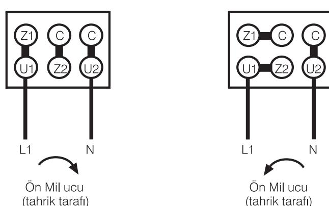
Kalkış + Daimi kondansatörlü motorlarda, elektronik kalkış rölesinin 6 ve 9 no.lu klemens bağlantıları (ana sargı uçları) değiştirilerek motor dönüş yönü değiştirilir.
